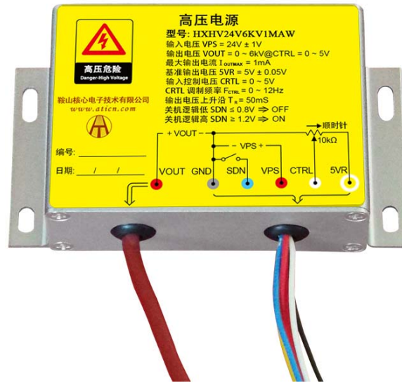
图 1、HXHV24V6KV1MAW 俯视图
